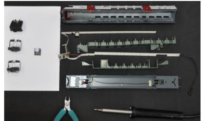
Führerstand zerlegen, Bohrung für FS-Beleuchtung fertigen, alten Beleuchtungskörper kürzen und mit Klebepunkt fixieren, Führerstand von vorn im rechten Winkel auf neuen Print aufsetzen und von links einschwenken, Decoder aufstecken
