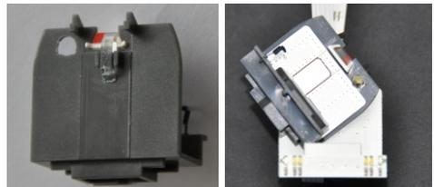
alte Beleuchtung entlöten und entnehmen, Litzen verlöten und isolieren, oberen Print im Gehäuse hinten anlegen und einkleben, Führerstand an der vorgesehenen Position einklicken, unteren Print an die Unterseite der oberen Inneneinrichtung kleben, dabei die Position der Kabinen beachten, Inneneinrichtung ins Gehäuse stecken, stromführende Kupplung durch den Federschacht führen, Chassis nach vorn ins Gehäuse stecken und einklicken
