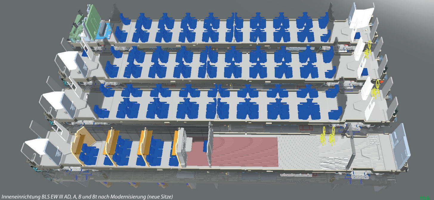
Inneneinrichtung BLS EW III AD, A, B und Bt nach Modernisierung (neue Sitze)
