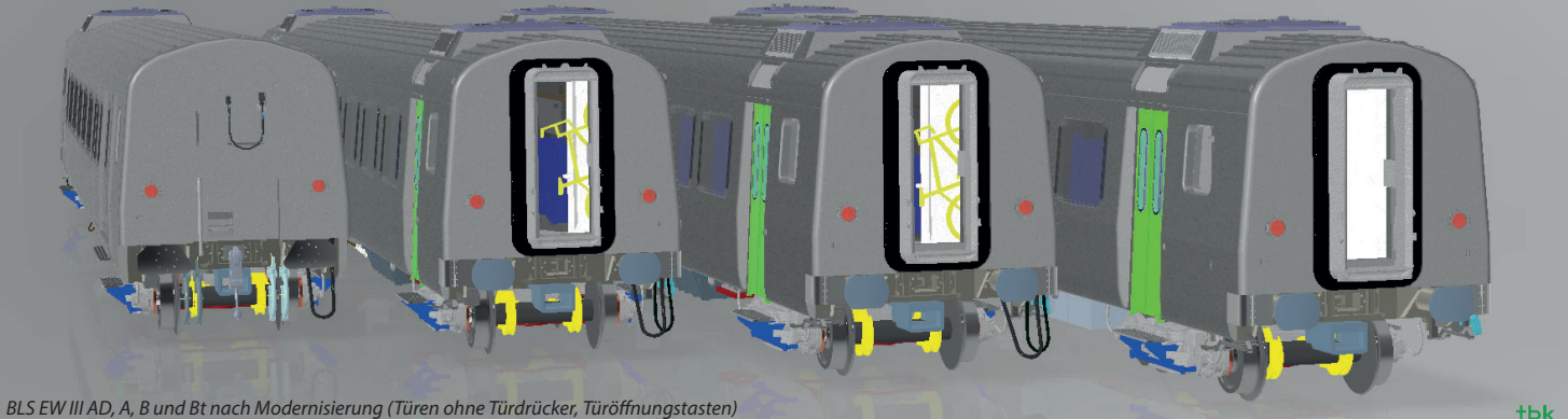
BLS EW III AD, A, B und Bt nach Modernisierung (Türen ohne Türdrücker, Türöffnungstasten)
