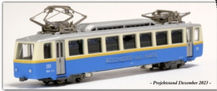
Nm-551.1: Bhe2/4 201ff. der Rochers-de-Naye-Bahn, Zahnradtrieb- wagen, motorisiert (angepasstes Industriefahrwerk)
