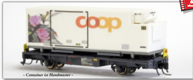
Nm-013.16: RhB Lb-v 7863, Tragwagen mit Coop-Kühlwechselbehälter Edellieschen (Minitrix), für Nm (6,5mm)
